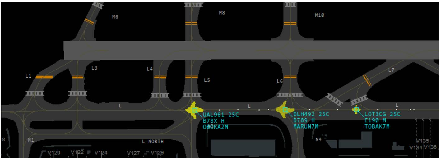
Im Bild haben wir folgende Konstellation: Zur Piste rollt vorne ein Heavy, danach noch ein Heavy, am Ende ein Medium. Wenn die Flieger jetzt in dieser Reihenfolge starten, braucht man zwischen den ersten beiden Heavies 4 NM und zwischen dem zweiten Heavy und dem Medium 5 NM. Insgesamt also 9 NM.
