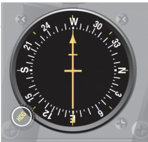
Ein RMI (Radio Magnetic Indicator) zeigt ebenfalls den Steuerkurs an, und man kann dadurch den Kurs, aus welchem das Signal kommt feststellen. Der RMI zeigt auch meistens Informationen zu einem VOR an (in diesem Bild die gelbe Nadel) und bei einem Glass Cockpit auch GPS-Wegpunkte.
